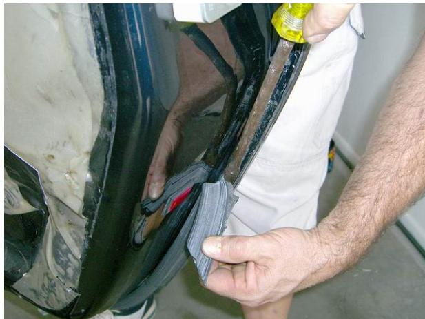
Ein gutes Moment, um die Profildichtung der Tür zu wechseln. Zu empfehlen sind die Dichtungen ab Baujahr 1991, da diese vorteilhaft geändert wurden.
