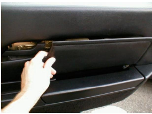
3. Türblende durch vorsichtiges Ziehen der Clips (4 Stück) lösen und nach oben heraus ziehen.
