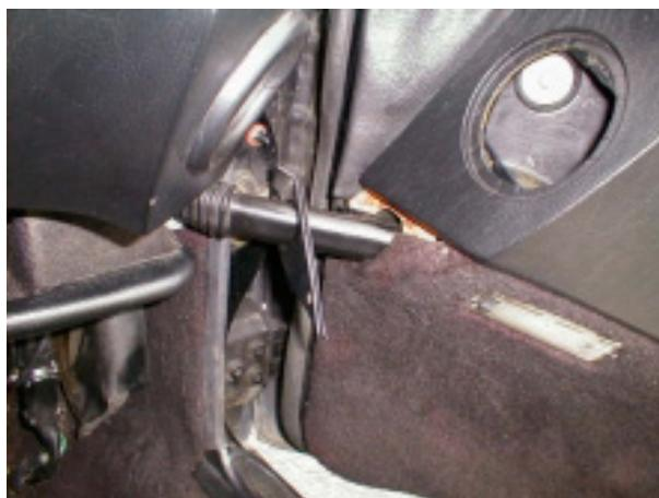
Die Abdeckung von der Tür „wegziehen“. Gummirosette der Türlüftung entfernen.
