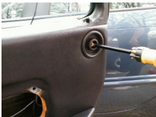
Linsenkopfschraube und U-Scheibe mittels Schraubendreher entfernen.
