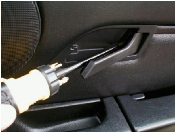
2. Innengriff ziehen und die sich dahinter befindliche Senkkopfschraube entfernen.
