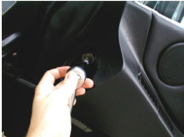
5. Entfernen der 4 Blechschräuben mittels 10 mm Stecknuss.
