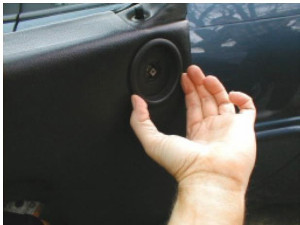
Drehknopf abziehen und Lagerschale gegen den Uhrzeigersinn herausdrehen.
