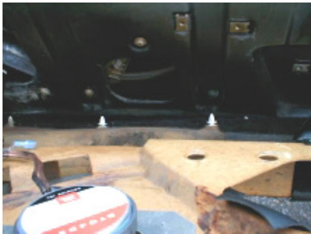
Die Verkleidung ist jetzt nur noch durch die weißen Clips und einen kleinen Metallwinkel, der sich oben links an der Verkleidung befindet, an der Tür befestigt.
